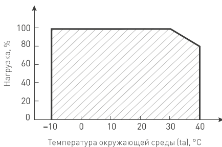
Рис. 2. Максимальная допустимая нагрузка, % от мощности источника
